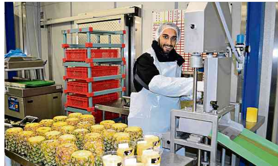
An einer Spezialmaschine werden frische Ananas geschält, geschnitten und verpackt. Reststücke werden in der eigenen „Cuisine Artisanale“ zu Smoothies.
